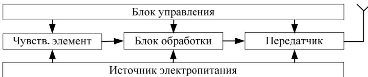
Рис. 1. Обобщенная структурная схема беспроводного датчика
